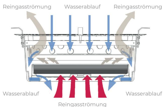
Durch das Siphonsystem wird eine gleichmässige Verteilung des Luftstroms gewährleistet. Das Wasser fliesst am Filter ohne Verschlechterung des hydraulischen Wirkungsgrades vorbei in den Kanal. Dies führt zu einer optimalen Belüftung des Kanalsystems und entfernt Gerüche zuverlässig, kostengünstig und mit geringem Wartungsaufwand.
